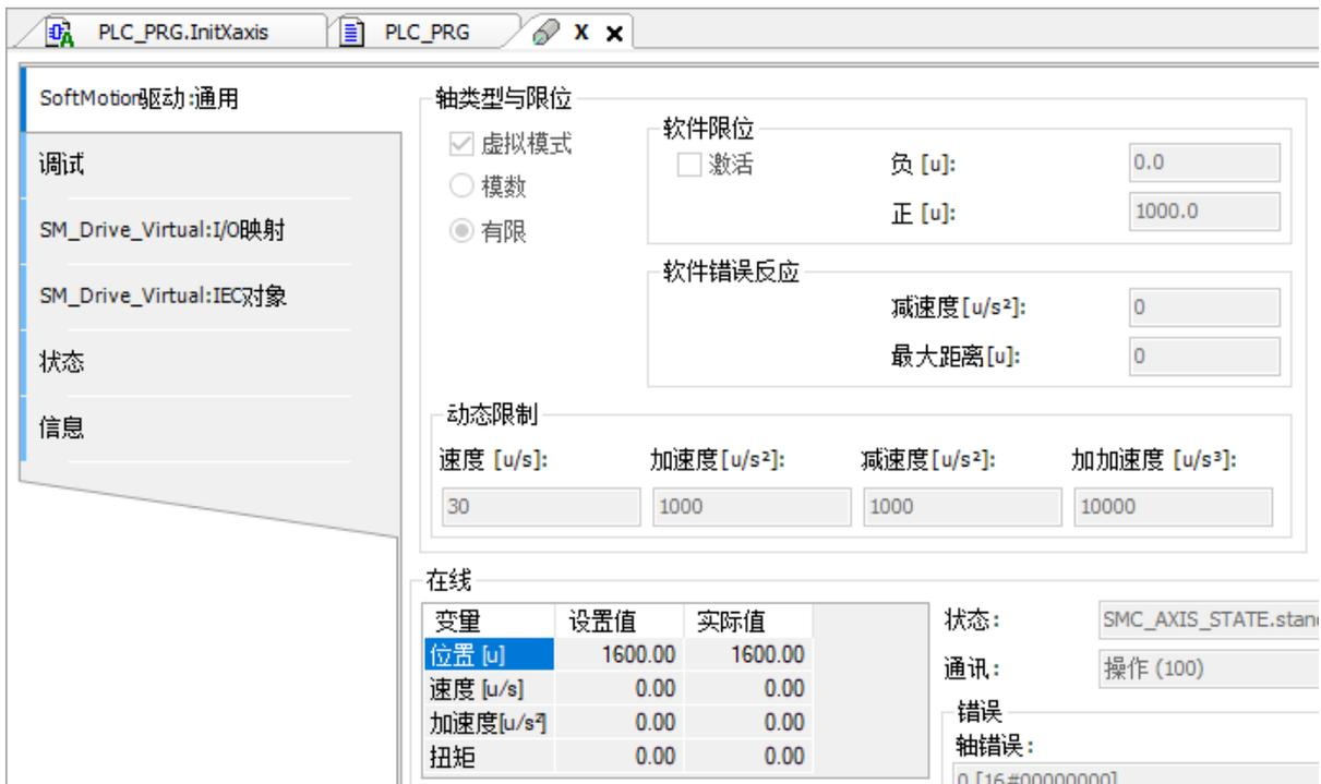
图 5.42 位置参数：位移 1600 个脉冲
